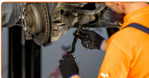
Výměna: kulového čepu řízení - BMW 3 Cabrio (E46). AUTODOC doporučuje:
