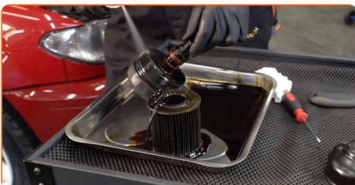
15 Nainstalujte nové o-kroužky a nový olejový filtr do jejich montážních míst na krytu filtru.
