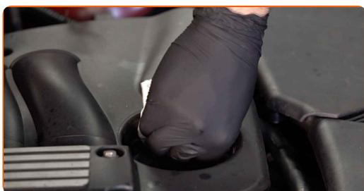
18 Namažte gumové těsnění nového filtru malým množstvím čerstvého oleje.
