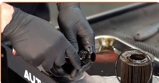
14 Vyčistěte uzávěr krytu olejového filtru. Použijte víceúčelový čisticí sprej.
