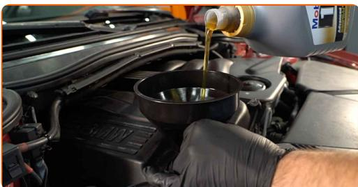
Výměna: motorového oleje a filtru - BMW 3 Cabrio (E93) cabrio.
