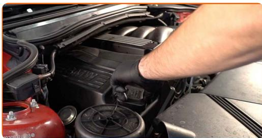
29 Motor nechte několik minut běžet. Po tom, co varovné světlo tlaku oleje zmizí, vypněte motor.
