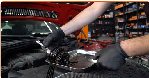
Výměna: motorového oleje a filtru - BMW 3 Cabrio (E93) cabrio. Doporučují odborníci z AUTODOC:
