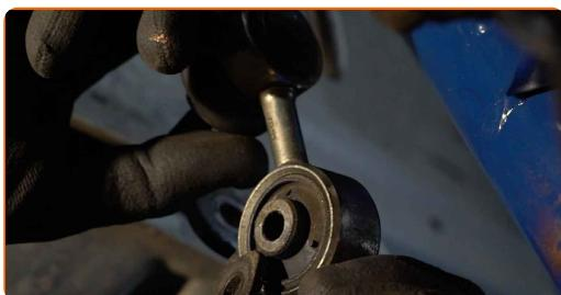
Výměna: tyčky stabilizátoru - BMW 3 Compact (E36). Doporučují odborníci z AUTODOC:
