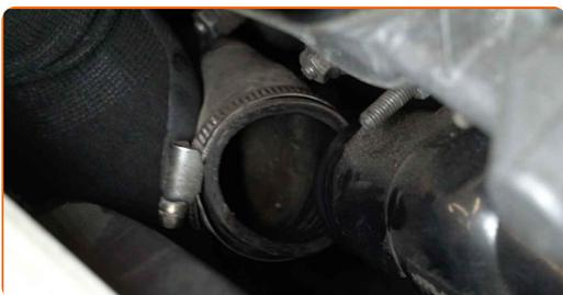
**14** Odpojte držák trubky chladicí kapaliny. Použijte nástavec č.13. Použijte ráčnový klíč.
