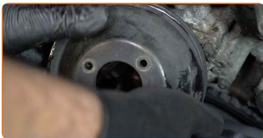
**24** Vyčistěte montážní pozici vodní pumpy. Použijte drátěný kartáč. Použijte víceúčelový čisticí sprej.
