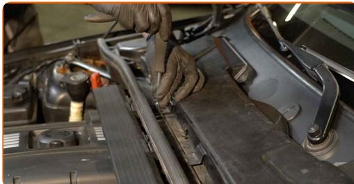
**4** Odstraňte kryt uložení kabinového filtru.
