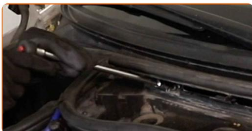
11 Odstraňte uložení kabinového filtru.
