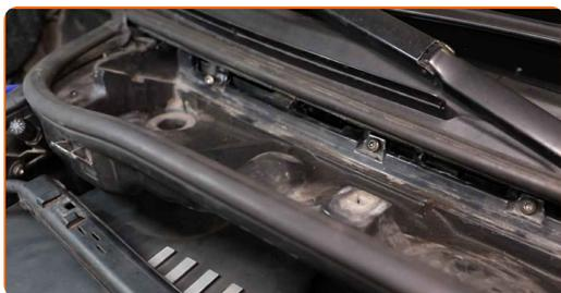
35 Zašroubujte upevňovací prvky krytu kabinového filtru. Použijte hvězdicový Torx T 30. Použijte ráčnový klíč.
