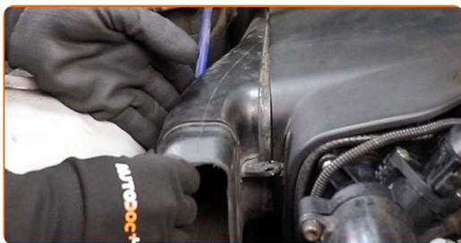
34 Nainstalujte uložení kabinového filtru.
