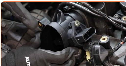
**23** Utáhněte upevňovací prvky snímače hmotnosti vzduchu. Použijte hvězdicový Torx T 25. Použijte momentový klíč. Utáhněte ji točivým momentem 8 Nm.
