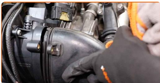
26 Utáhněte upevňovací prvky, které spojují vzduchové vedení ke snímači množství vzduchu. Použijte imbusový klíč č. H5. Použijte momentový klíč. Utáhněte ji točivým momentem 5 Nm.
