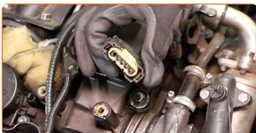
**20** Odšroubujte upevňovací prvky snímače hmotnosti vzduchu. Použijte hvězdicový Torx T 25. Použijte ráčnový klíč.
