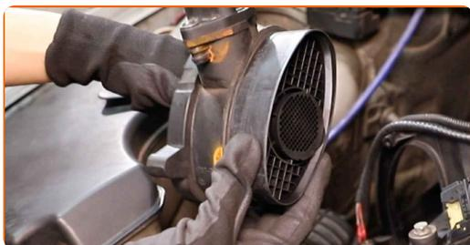
**22** Nainstalujte nový snímač proudění vzduchu.
