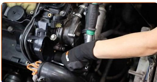
**24** Odstraňte ručník z mikrovlákna ze vzduchové přívodní hadičky.
