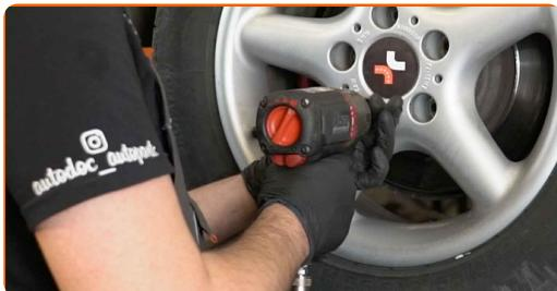
Výměna: tyčky stabilizátoru - BMW 5 Touring (E39). AUTODOC doporučuje:
