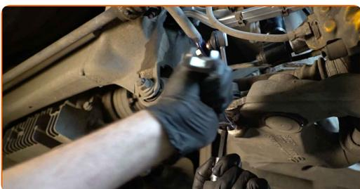
**13** Utáhněte upevňovací prvek spojující stabilizátor s ovládacím ramenem. Použijte nástavec č.18. Použijte momentový klíč. Utáhněte ji točivým momentem 100 Nm.
