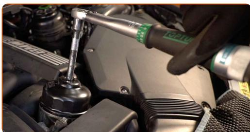
**29** Odstraňte uzávěr olejového systému. Vložte trychtýř.
