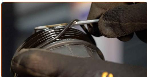
23 Vyčistěte uzávěr krytu olejového filtru. Použijte víceúčelový čisticí sprej.
