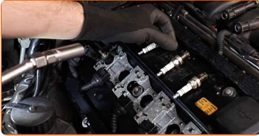
17 Aplikujte tenkou vrstvu speciálního vysokoteplotního maziva proti zadření na závity nových svíček zapalování.
