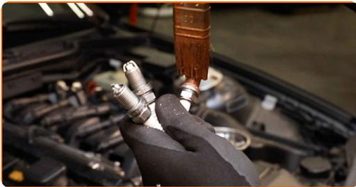
18 Nainstalujte nové svíčky zapalování do otvorů pro jejich montáž. Použijte klíč na svíčky zapalování č. 16.
