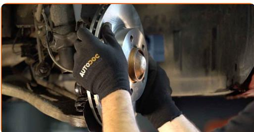
**21** Upevněte upevnění brzdového kotouče. Použijte hvězdicový Torx T 30. Použijte momentový klíč. Utáhněte ji točivým momentem 16 Nm.
