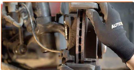
**16** Vyčistěte povrch brzdového kotouče. Použijte drátěný kartáč. Použijte sprej WD-40.
