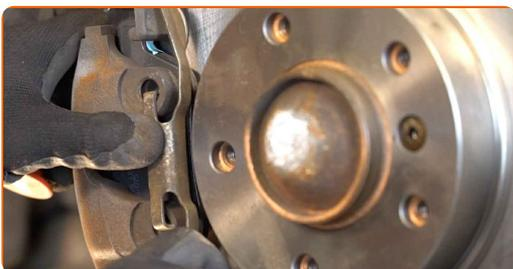
**32** Vyčistěte povrch brzdového kotouče. Použijte čistič brzd.
