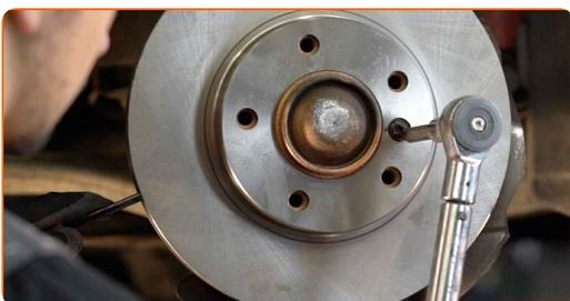
**22** Nainstalujte svorku brzdového třmenu.
