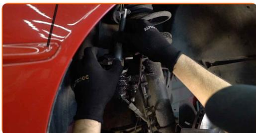
**28** Nainstalujte brzdové destičky do brzdového třmenu.
