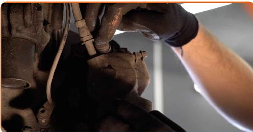
**31** Nainstalujte zádržnou pružinu brzdového třmenu.
