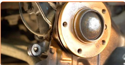
**20** Nainstalujte brzdový kotouč.
