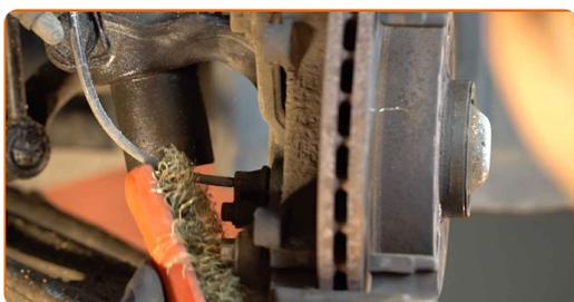
**14** Odšroubujte upevnění svorky brzdového třmenu. Použijte nástavec č.16. Použijte vratidlo. Použijte ráčnový klíč.
