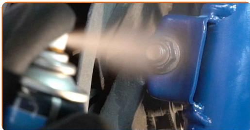
**43** Vyčistěte montážní otvor disku kola. Použijte drátěný kartáč.
