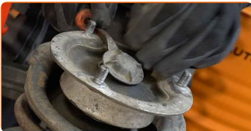
**22** Natřete tyč vzpěry tlumiče. Použijte drátěný kartáč. Použijte sprej WD-40.
