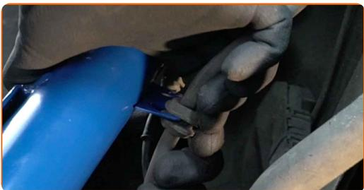
**41** Zapojte konektory ABS snímače.
