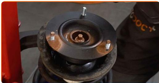
**29** Nainstalujte kryt ložiska vzpěry tlumiče.
