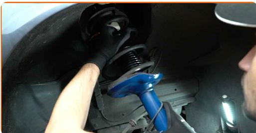
**34** Zajistěte vrchní upevnění vzpěry tlumiče. Neutahujte ho.
