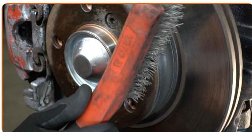
**44** Natřete povrch, kde je brzdový kotouč v kontaktu s ráfem kola. Použijte měděné mazivo.
