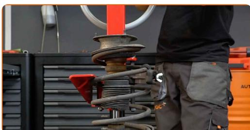
**21** Odstraňte kryt ložiska vzpěry tlumiče. Použijte páčidlo.
