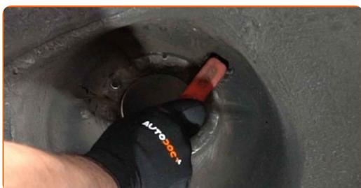
**33** Nainstalujte vzpěru tlumiče do oblouku kola.
