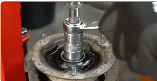
**24** Odstraňte uložení tlumiče, návlek a tlumící doraz.
