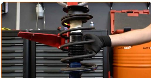
**32** Natřete montážní prvek vzpěry tlumiče na hlavě ložiska čepu kola. Použijte drátěný kartáč. Použijte sprej WD-40.
