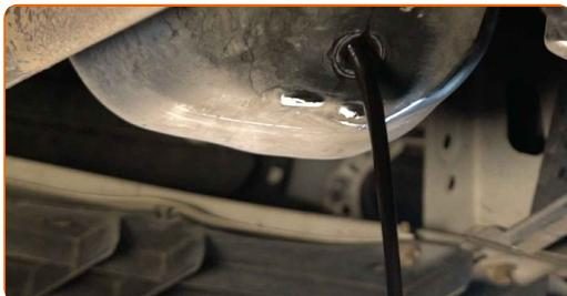
**Výměna: motorového oleje a filtru - Citroen C1 1 PM PN. Doporučují odborníci z AUTODOC:**
