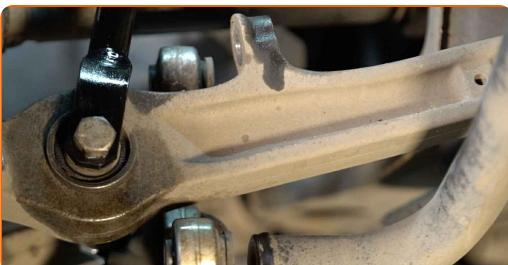
Výměna: tyčky stabilizátoru - Audi A6 4F2. Doporučují odborníci z AUTODOC:
