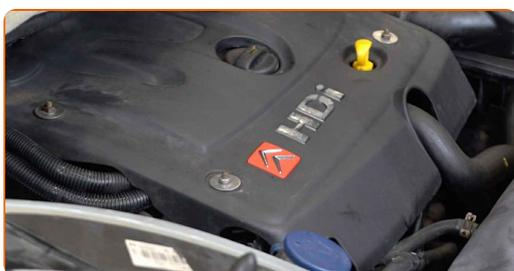
24 Zkontrolujte stav oleje po 5 minutách po zastavení motoru použitím měřky. Pokud bude třeba, přidejte více oleje.
