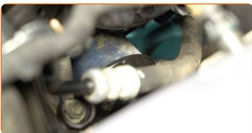
**5** Připravte nádobu pro starý olejový filtr. Starý olejový filtr vložte do nádoby.
