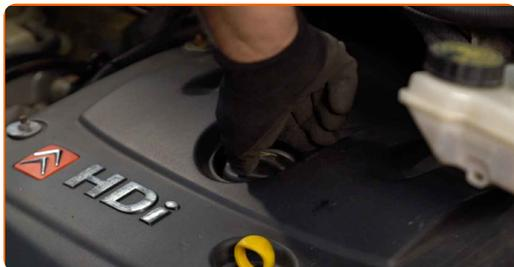
23 Motor nechte několik minut běžet. Po tom, co varovné světlo tlaku oleje zmizí, vypněte motor.
