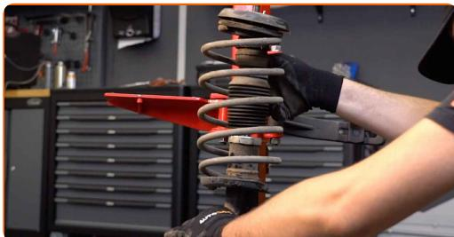
Výměna: pérovací jednotka - CITROËN C2 Enterprise (JG\_). Tip od odborníků z AUTODOC:
