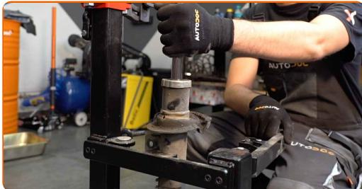
Výměna: pérovací jednotka - CITROËN C2 Enterprise (JG\_). Tip od AUTODOC:
