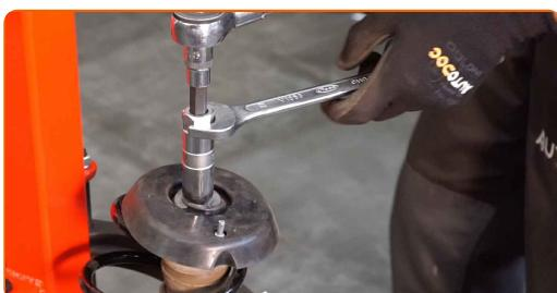
Výměna: pérovací jednotka - CITROËN C2 Enterprise (JG\_). Profesionálové doporučují:
