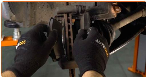
Výměna: brzdové destičky - CITROËN C2 Hatchback (JM). Doporučují odborníci z AUTODOC:
