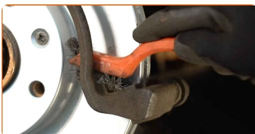
Výměna: brzdové destičky - CITROËN C2 Hatchback (JM). Profesionálové doporučují:
