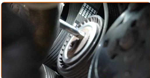
Výměna: drážkového řemene - CITROËN C2 Hatchback (JM). Tip:
