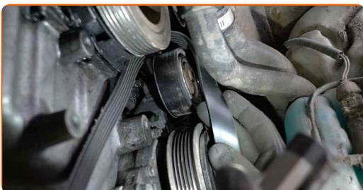
Výměna: drážkového řemene - CITROËN C2 Hatchback (JM). Tip od odborníků z AUTODOC:
