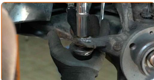
**73** Utáhněte upevňovací matici spojující čep táhla řízení k hlavě ložiska čepu kola. Použijte nástavec č.17. Použijte momentový klíč. Utáhněte ji točivým momentem 35 Nm.
