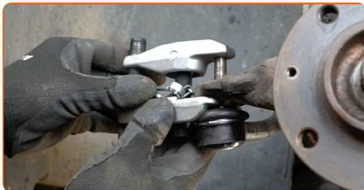
**27** Vyčistěte všechna spojení ramene. Použijte drátěný kartáč. Použijte sprej WD-40.
