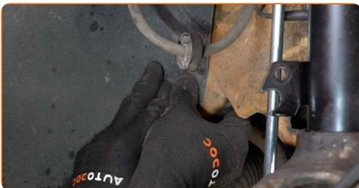
**70** Vyčistěte montážní pozice čepu táhla řízení. Použijte drátěný kartáč. Použijte sprej WD-40.
