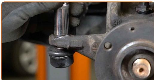
**74** Utáhněte upevňovací prvky spojující kulový čep k ovládacímu ramenu. Použijte nástavec č.16. Použijte momentový klíč. Utáhněte ji točivým momentem 60 Nm.
