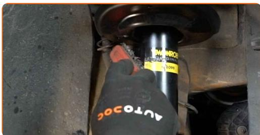
**10** Odšroubujte upevnění spojující vzpěru stabilizátoru a vzpěru tlumiče. Použijte nástavec č.17. Použijte ráčnový klíč.
