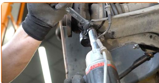
**29** Odpojte kulový čep z ramene. Použijte páčidlo.
