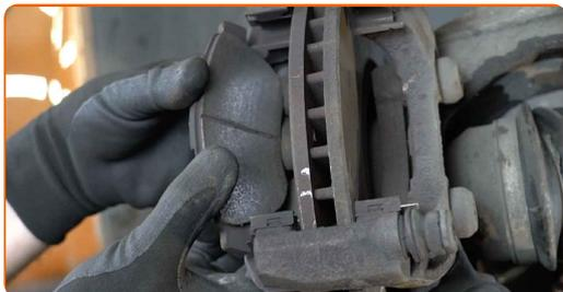
**12** Vyčistěte upevňovací prvky držáku brzdového třmenu. Použijte drátěný kartáč. Použijte sprej WD-40.
