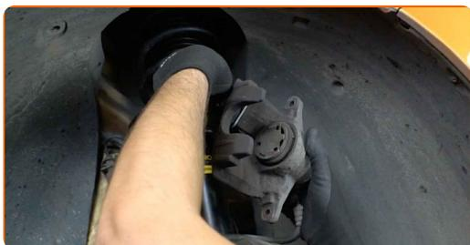
Výměna: brzdového kotouče - CITROËN C3 II (SC\_). Tip od odborníků z AUTODOC:
