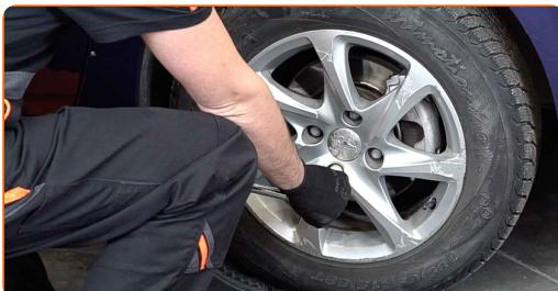
3 Uvolněte upevňovací prvek hnací hřídele. Použijte nástavec č.32. Použijte vratidlo.
