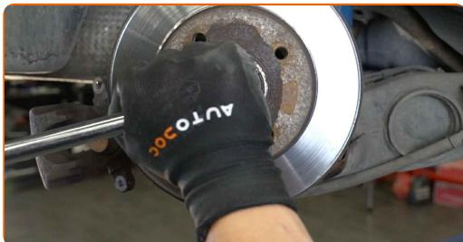
**19** Odstraňte brzdový kotouč, který je v jedné sestavě s ložiskem náboje kola. Použijte stahovák s kluzným kladivem na náboj kola.
