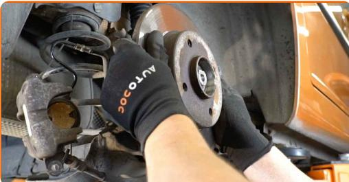
**20** Vyčistěte čep nápravy. Použijte drátěný kartáč. Použijte víceúčelový čistící sprej.
