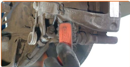
**10** Odšroubujte upevnění brzdového třmenu. Použijte kombinační klíč č.19. Použijte nástavec č.13. Použijte ráčnový klíč.
