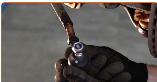
**Výměna: kulového čepu řízení - CITROËN C4 I Sedan. AUTODOC doporučuje:**
