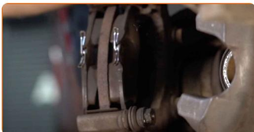
Výměna: brzdového kotouče - CITROËN C4 II Van / Hatchback (NC\_).
