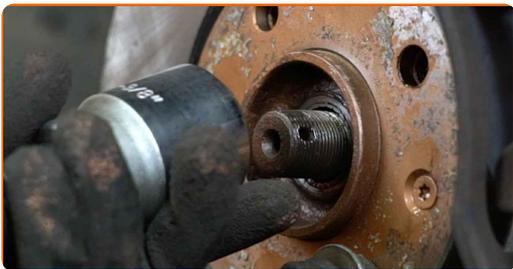
**9** Vyčistěte upevňovací prvky vzpěry stabilizátoru. Použijte drátěný kartáč. Použijte sprej WD-40.
