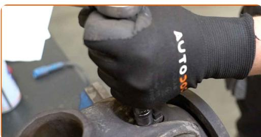
**54** Natřete montážní prvek vzpěry tlumiče na hlavě ložiska čepu kola. Použijte drátěný kartáč. Použijte sprej WD-40.
