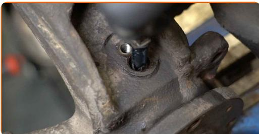
**53** Utáhněte upevňovací prvek, který spojuje ABS senzor k hlavě ložiska čepu řízení. Použijte nástavec č. 13. Použijte momentový klíč. Utáhněte ji točivým momentem 10 Nm.
