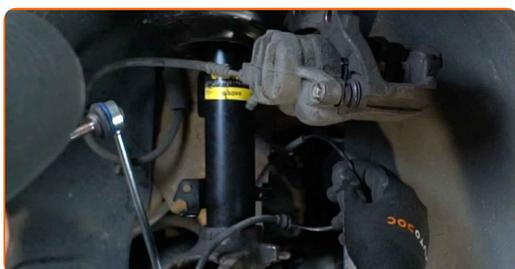
**66** Ošetřete konektor ABS snímače. Použijte dielektrické mazivo.
