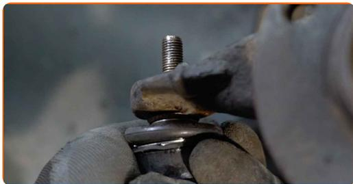
**72** Zašroubujte upevňovací matici, která spojuje čep táhla řízení k hlavě ložiska čepu řízení. Použijte nástavec č.17. Použijte ráčnový klíč.
