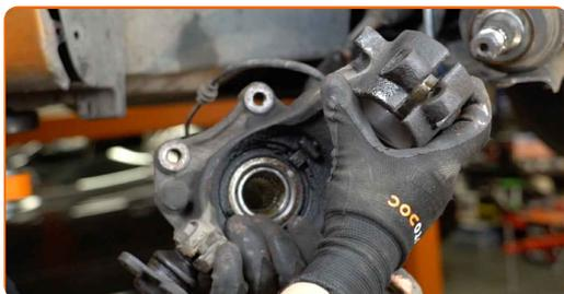
**36** Do svěráku chytěte hlavu ložiska čepu řízení v sestavě s nábojem kola.
