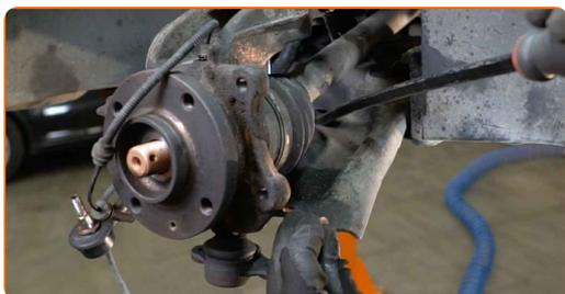
**64** Zašroubujte upevňovací prvky kulového čepu. Použijte nástavec č.16. Použijte ráčnový klíč.
