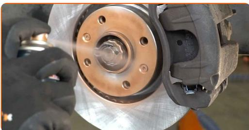
**16** Vyčistěte povrch brzdového kotouče. Použijte čistič brzd.
