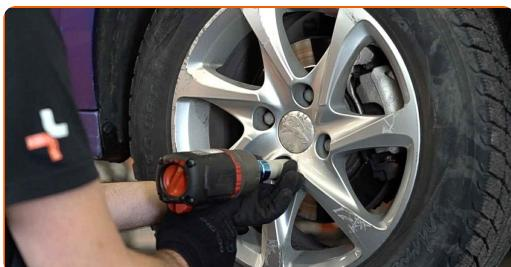
Výměna: brzdového kotouče - CITROËN Xsara Van / Hatchback (N3\_). Tip:
