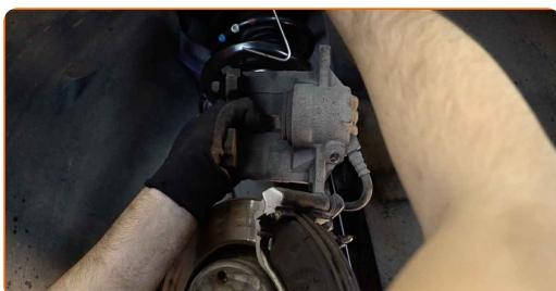
Výměna: brzdového kotouče - CITROËN Xsara Van / Hatchback (N3\_).
