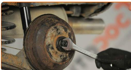
**24** Nainstalujte závlačku upevňovací matici ložiska náboje. Použijte kulaté kleště.
