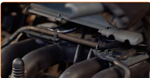
**4** Odstraňte konektory vodičů svíčky zapalování z otvorů pro svíčky zapalování. Použijte kulaté kleště.
