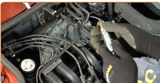
**8** Aplikujte tenkou vrstvu speciálního vysokoteplotního maziva proti zadření na závity nových svíček zapalování.
