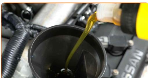
Výměna: motorového oleje a filtru - DACIA Duster II. Doporučují odborníci z AUTODOC:
