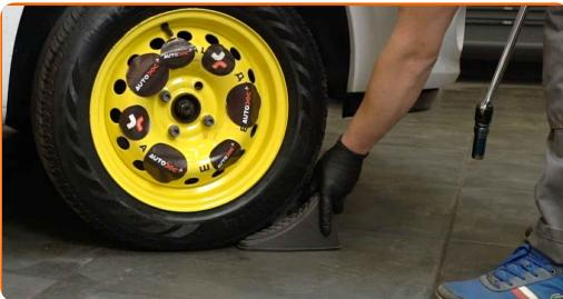
**4** Uvolněte upevňovací šrouby kola. Použijte rázový nástavec na kolo č. 17.
