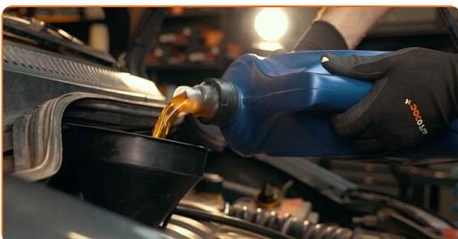
Výměna: motorového oleje a filtru - DACIA LOGAN (LS\_). Tip od odborníků z AUTODOC:
