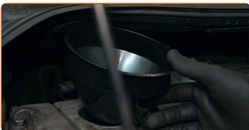
**20** Nový olej nalijte do motoru, a to v množství, které doporučuje výrobce auta.
