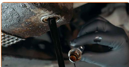
Výměna: motorového oleje a filtru - DACIA LOGAN (LS\_). Tip:
