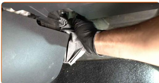
Výměna: kabinového filtru - DACIA LOGAN (LS\_). AUTODOC doporučuje:
