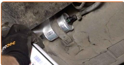
**13** Nádobu na kapalinu odstraňte zpod palivového filtru.
