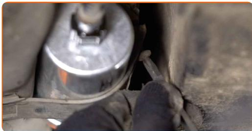
**12** Vyčistěte upevňovací prvky hadiček na dodávku paliva. Použijte víceúčelový čisticí sprej.
