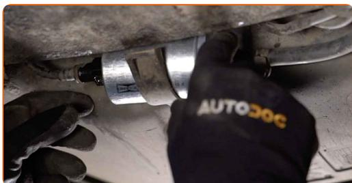
**11** Utáhněte upevňovací prvky palivového filtru. Použijte křížový šroubovák PH.
