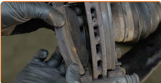
Výměna: brzdové destičky - DACIA LOGAN pick-up (US\_). AUTODOC doporučuje:
