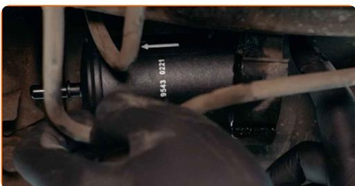
Výměna: palivového filtru - DACIA LOGAN pick-up (US\_). Tip od AUTODOC:
