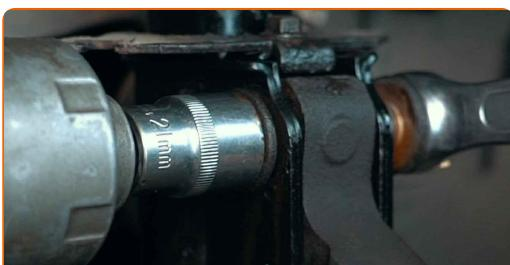
**52** Utáhněte spodní upevňovací prvky spojující vzpěru tlumiče k hlavě ložiska čepu. Použijte kombinační klíč č.21. Použijte nástavec č.21. Použijte momentový klíč. Utáhněte ji točivým momentem 170 Nm.
