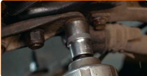
**50** Utáhněte upevňovací prvky spojující kulový čep k ovládacímu ramenu. Použijte nástavec č.18. Použijte momentový klíč. Utáhněte ji točivým momentem 75 Nm.
