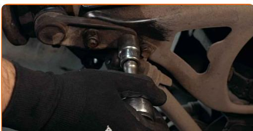
**51** Zašroubujte upevňovací prvky spojující tlumič k hlavě ložiska čepu kola. Použijte kombinační klíč č.21. Použijte nástavec č.21. Použijte ráčnový klíč.
