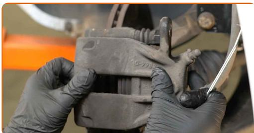
Výměna: brzdového kotouče - Dacia Sandero. Doporučují odborníci z AUTODOC:
