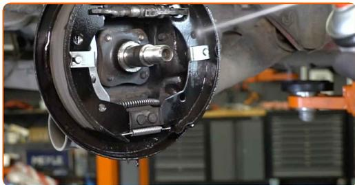
**16** Nainstalujte brzdový buben v sestavě s ložiskem náboje.
