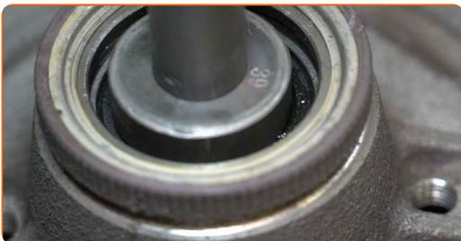
**12** Vyčistěte montážní otvor ložiska náboje. Použijte drátěný kartáč.
