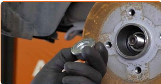
**9** Odstraňte brzdový buben sestavený s ložiskem náboje kola.
