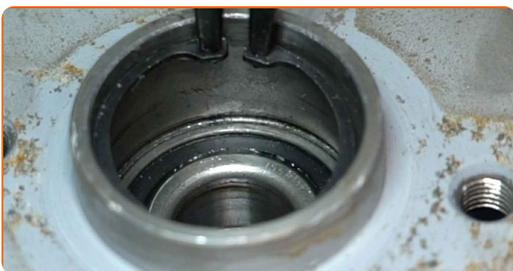
**11** Vytláče ložisko náboje kola. Použijte sadu vložky a ořechu ložiska.
