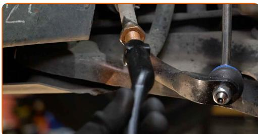
**Výměna: kulového čepu řízení - DS DS 3 Cabriolet. Tip od odborníků z AUTODOC:**
