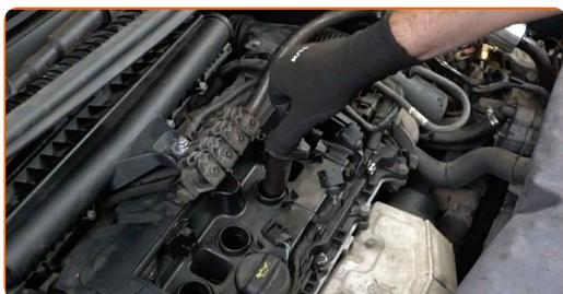
**Výměna: zapalovacích svíček - DS DS 4 / DS 4 CROSSBACK. Tip:**
