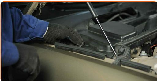
**50** Nainstalujte a zajistěte plastový kryt pod stěrače umístěný na pravé straně.
