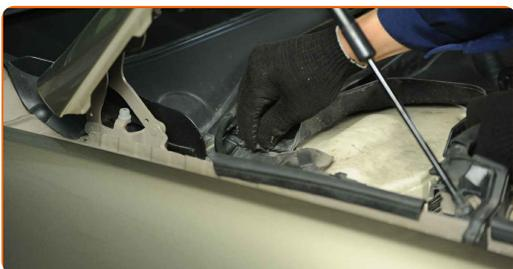
**13** Zvedněte a odstraňte mřížku pro odvádění vody.
