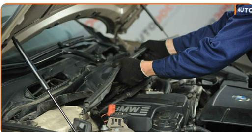
**45** Nainstalujte upevňovací prvky plastového krytu pod stěrače.
