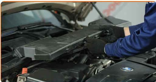
**12** Odstraňte držáky plastové mřížky pro odvádění vody.
