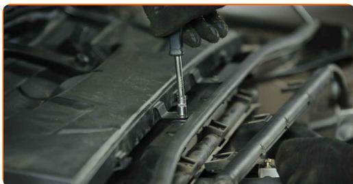
**11** Odstraňte kryt uložení kabinového filtru.
