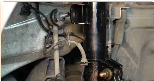
Výměna: tyčky stabilizátoru - FIAT 500L (351, 352). AUTODOC doporučuje:
