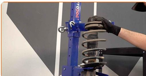
Výměna: uložení tlumiče - FIAT Bravo II Van (198). Doporučují odborníci z AUTODOC:
