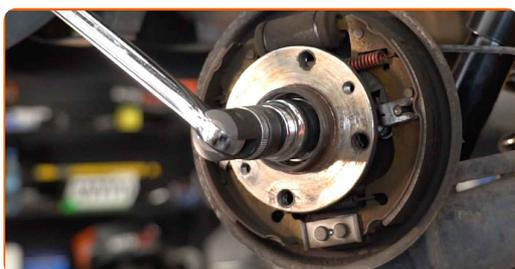
**11** Spolu odstraňte náboj a ložisko, protože tyto dva prvky jsou smontovány do sebe.
