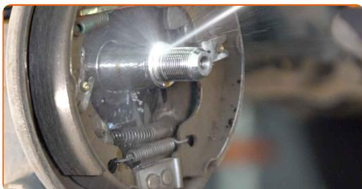
**13** Nainstalujte nový náboj kola s ložiskem.
