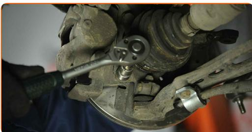
**40** Zapojte upevnění brzdové hadičky k vzpěře tlumiče.
