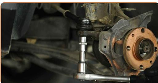
**14** Odpojte koncovku táhla od kloubu řízení. Použijte stahovák na kulové čepy.
