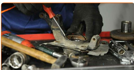
**29** Vtlačte náboj kola do vnitřního prstence ložiska.
