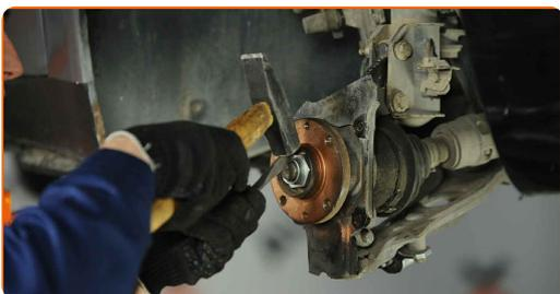
**37** Nainstalujte brzdový kotouč a zajistěte jej. Použijte nástavec č.12.
