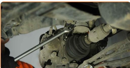
**7** Odstraňte brzdový třmen spolu s jeho držákem.
