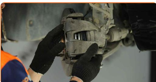
**39.2** Utáhněte upevňovací prvky držáku brzdového třmenu. Použijte nástavec č.12.
