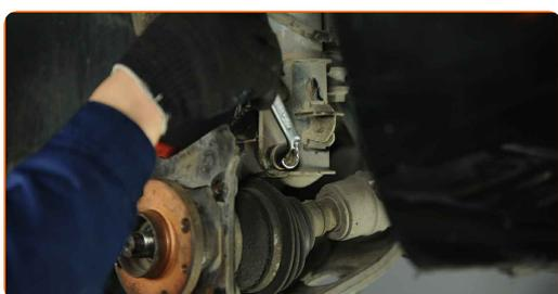
**34** Nainstalujte snímač ABS na táhlo řízení a zajistěte jej. Použijte nástavec č.10.
