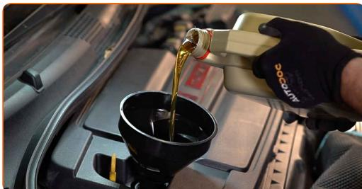
Výměna: motorového oleje a filtru - FIAT DOBLO karoserie/kombík (263).
