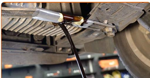
**Výměna: motorového oleje a filtru - FIAT DOBLO karoserie/kombík (263). Tip:**
