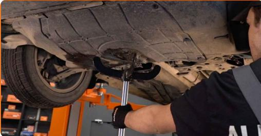
**7** Odstraňte kryt olejové vany. Odstraňte hydraulický převodovový zvedák.
