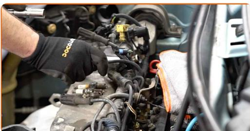
**13** Aplikujte tenkou vrstvu speciálního vysokoteplotního maziva proti zadření na závity nových svíček zapalování.
