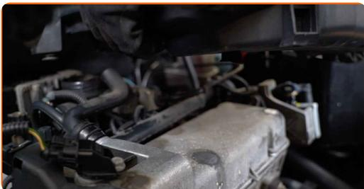
**6** Překryjte tělo škrticí klapky ručníkem z mikrovlákna, aby se do systému nedostal prach a špína.
