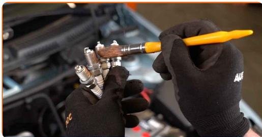
**14** Nainstalujte nové svíčky zapalování do otvorů pro jejich montáž. Použijte klíč na svíčky zapalování č. 16.
