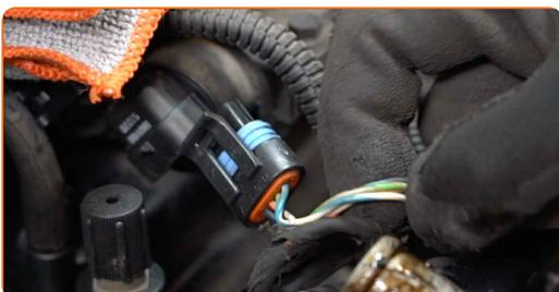
**9** Odstraňte konektory vodičů svíčky zapalování z otvorů pro svíčky zapalování.
